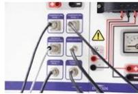
Para poder controlar el encendido y apagado de los focos, los conectamos al equipo por la parte trasera del módulo MP-EF10 Control fotovoltaica con-PC.¶
